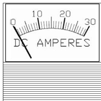
Fig. 16 Ammeter (Amp Meter)
