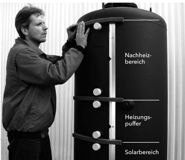
Bild 27 Um Konvektionsverluste im Bereich der Speicheranschlüsse zu vermeiden, die beiliegenden, selbstklebenden Dämmstreifen waagrecht an den im Bild gezeigten Positionen anbringen.
