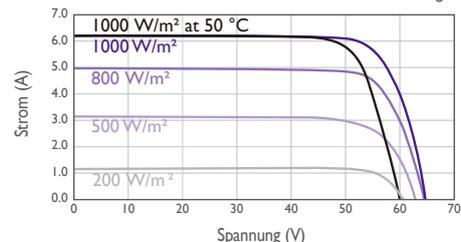
Strom-Spannung-Kennlinie in Abhängigkeit von Strahlungsstärke und Temperatur des Moduls.
