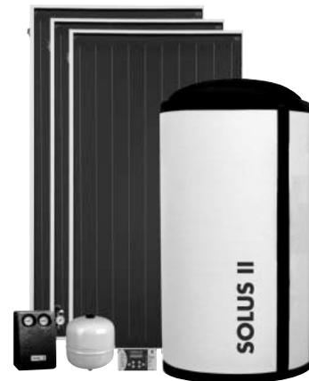
Jedes Paket enthält den Speicher mit der Spezial-EPS-Luftpolster-Dämmung für geringe Wärmeverluste, einen Solarregler CONTROL 601 (inkl. Kollektorfühler sowie zwei Speicherfühlern), einen Warmwassermischer als Verbrühschutz und die CON-SOLARSTATION III 35/6. Außerdem gehören vier weitere Temperaturfühler (RE046) zum Lieferumfang.
