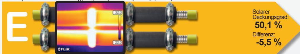
Rohre, 9 mm Dämmung,  $\lambda_{40^\circ} = 0,045 \text{ W/mK}$  (0,042)
