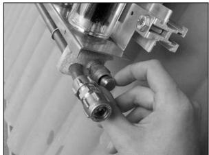
..oder B /C: beide Sammlerrohre am Ende mit einem Blindstopfen bzw. mit Klemmverschraubung und Blindstopfen verschließen:
