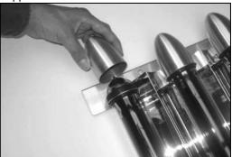
Röhre mit Schmierseife oder Spüli schmieren; Gummihalterung ebenfalls:
