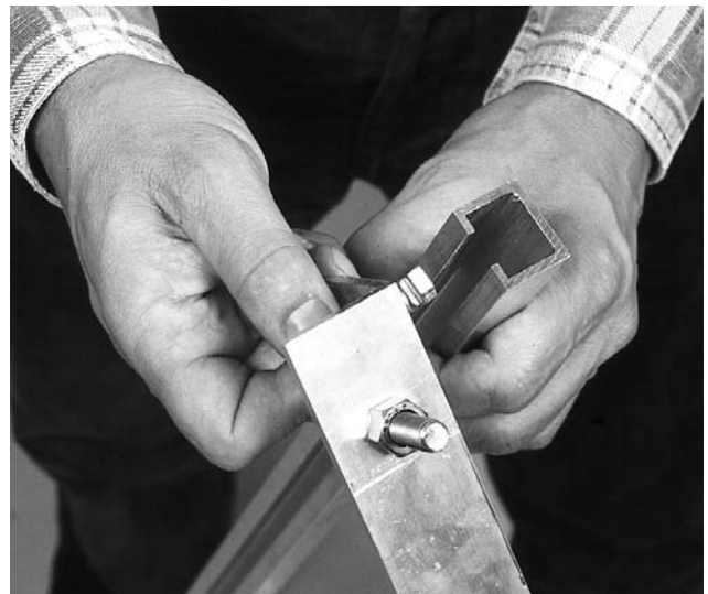
Bild 14 Aus diesen Kollektorprofilen (Bauteil ①, S. 2f) u. Verstellbaren Dreiecken zusammensetzen. Schienen entsprechend Aufstellwinkel befestigen (Tab. 1). Eventuellen Überstand absägen.
