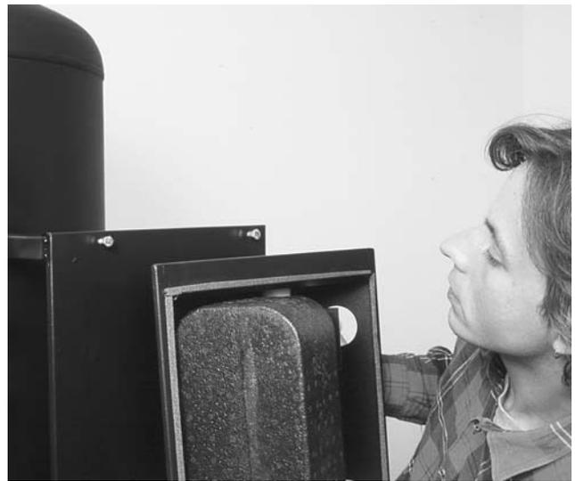
Bild 19 Schlosssechskantschrauben halb in die Montageplatte eindrehen. Dann Gehäuseunterteil mit Schlüsselbohrungen einhängen und Schlossschrauben festziehen.
