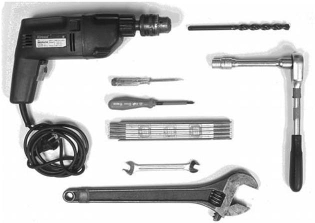
Bild 4 Sie benötigen folgendes Werkzeug: Bohrmaschine, Steinbohrer (12mm), Spannungsprüfer, Schraubendreher, Gliedermaßstab, 10er Maulschlüssel, Rollgabelschlüssel, Ratsche mit 13er Nuss
