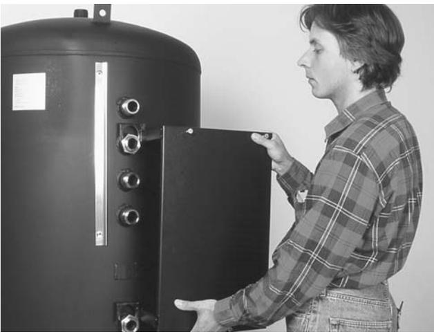
Bild 18 Option "Anbausatz RATIO-H": Dämmung entfernen, Montageplatte an dem zweiten und fünften Anschluss von oben einhängen.
