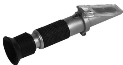
Abb. 23 Für eine genaue Messung des Frostschutzes mit dem Refraktometer genügen wenige Tropfen der gemischten Solarflüssigkeit
