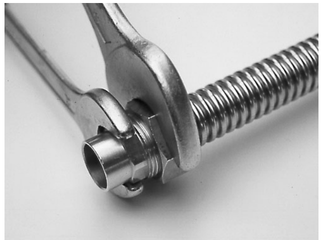
Abb. 6 Überwurfmutter mit einem Schraubenschlüssel halten und Übergangsnippel fest einschrauben. Anschließend Übergangsnippel und Unterlegscheibe wieder herausnehmen.
