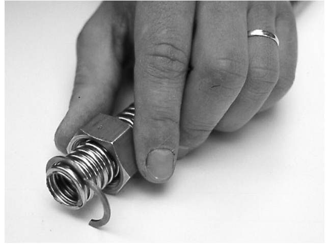
Abb. 4 Überwurfmutter auf Schlauch schieben. Dann Klemmring in das erste Wellental einlegen und zusammendrücken. Wenn Sie eine Rohrzange verwenden, Schlauch bitte nicht beschädigen.
