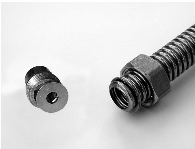
Abb. 5 Jetzt wird die Welle am Rohrende zu einer Dichtfläche zusammengestaucht. Hierzu dient eine passende Unterlegscheibe, die in die Überwurfmutter eingelegt wird.
