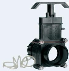
zur schnellen Entleerung von Tanks. Auf der einen Seite ist ein Gewindeauslass 1½" (38 mm) mit Schraubdeckel, auf der anderen Seite ein Einlass zum Einkleben in Gegenstück # 242942
