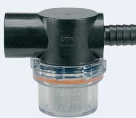
zum direkten Aufschrauben auf SHURflo-Pumpen. Feinmaschiges, rostfreies Metallsieb stoppt Teile, die sonst Pumpe und Wasseranlage schädigen könnten. Die aufgeschraubte transparente Filtertasse ermöglicht eine einfache Reinigung, trinkwasserecht.
