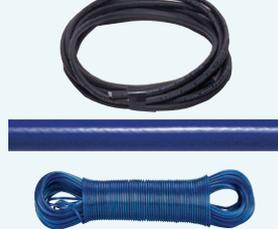
für Tiefbrunnenpumpe Solar #9300, bestehend aus: 100 m lebensmittelechtem Gewebeschlauch: 12x3mm (blau), 100 m Kabel: 2x1,5 mm<sup>2</sup> (für den Außeneinsatz geeignet), 100 m Halteseil zur Befestigung, jeweils auf 100 m Rollen, d.h. keine Nahtstellen und absolute Wasserdichtheit.
