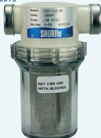
zum Einbau in die Ansaugleitung vor die Pumpe. Der große feinmaschige, rostfreie Metallsiebkorb hält Schwebstoffe und Verschmutzung zurück, z.B. Marine. Der durchsichtige Deckel lässt erkennen, wann eine Säuberung nötig ist. Durch Drehverschluss einfache Reinigung. Passende Tüllen für Schlauchanschluss 12 oder 19 mm siehe unten.
