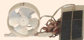
der einfach und schnell zu installierende Solar-Kühlschrank-Ventilator verbessert die Kühlleistung um bis zu 30 %, indem er den Luftwechsel am Wärmetauscher des Kühlschranks verstärkt; dadurch niedrigerer Stromverbrauch und längere Lebensdauer des Kühlschranks; keine Batteriebelastung, umweltfreundlich und geräuscharm; arbeitet dann,
