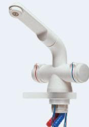
mit keramischen Dichtscheiben. Durch die Beständigkeit und die hohe Härte der Keramik sind eine exakte Steuerung und optimale Abdichtung für lange Zeit garantiert. Die Wassermenge ist feinregulierbar. Auslauf drehbar, mit Perlator und Rosette
