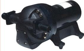
Sensorpumpen mit 5-Kammer-Membran mit sehr hoher Leistung und variabler Anpassung der Förderleistung aus der Extreme™ Serie. Die Elektronik steuert die Motordrehzahl und damit die benötigte Wassermenge. Die Sensorpumpen fördern je nach Bedarf und Modell von 0 bis 20
