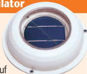
sobald Sonnenlicht auf die Solarzellen des Ventilators fällt, saugt er Luft ab und hilft so beim Kühlen. Das Gehäuse ist aus spritzwassergeschütztem Kunststoff. Zur Montage einen Ausschnitt erstellen und von oben verschrauben. Wir empfehlen die Abdichtung mit Sikaflex.
