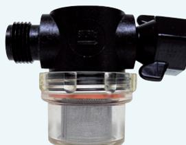
zum direkten Aufschrauben auf SHURflo-Pumpen. Feinmaschiges, rostfreies Metallsieb stoppt Teile, die sonst Pumpe und Wasseranlage schädigen könnten. Die aufgeschraubte transparente Filtertasse ermöglicht eine einfache Reinigung.
