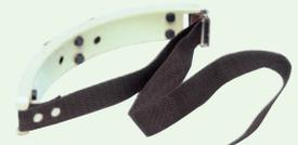
aus Stahl mit Schutzlackierung, extrem stabil, ist dem Radius der Flasche exakt angepaßt (d.h. Ø von 240 bzw. 330 mm). Die Flasche liegt auf 6 in den Halter eingefaßten Gummipuffern auf und ist sicher fixiert. Mit Schnellverschluss, wodurch der Gurt nur beim 1. Mal festzustellen ist. Die Montage erfolgt mit 2 Schrauben durch Löcher im rechtwinkligen Befestigungswinkel.
