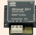
zum Verteilen des Ladestroms auf drei voneinander unabhängige Batterien. Jede Batterie kann über eine eigene Ladestromquelle verfügen. Erreicht eine Batterie eine Spannung von 13,8 V, werden alle Batterien parallel geschaltet, fällt sie unter 13,0 V werden sie automatisch getrennt.
