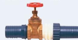
Der Tankablaufstutzen wird mit 40 mm Schlauch mit der Garnitur verbunden. Die Überwurfmutter bleibt bei montiertem Schlauch drehbar. Mit Anschlussstülle # 73440B, Muffenschieber # 24280, Übergangsnippel # 24120, Verschraubung # 74540.
