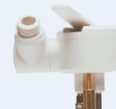
weiß, mit keramischen Dichtscheiben. Durch die Beständigkeit und die hohe Härte der Keramik sind eine exakte Steuerung und optimale Abdichtung für lange Zeit garantiert. Die Wassermenge ist feinregulierbar, die Temperatur stufenlos dosierbar. Auslauf dreh- und schwenkbar, mit Perlator, Fixierung erfolgt mittels zweier Messingschrauben mit Ø 5 mm, Lochabstand Mitte-Mitte 38 mm, mit schwenkbarem Brauseanschluss
