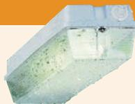
in Naß-, Motorenräumen oder außen einsetzbar. Die Abschlußwanne hat klare Innenprismen und ein Mehrfachschamier, das abklappbar und aushängbar ist. Die Leuchte ist staub-, schlag- und strahlwassergeschützt (nach IP65). Die Elektronik wird durch das Reflektorblech geschützt.
