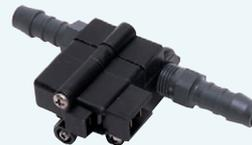
für Druckpumpen. Verhindert das Anspringen der Pumpe bei leerem Tank. Wird hinter der Pumpe in die Druckleitung eingebaut. Solange die Pumpe Wasser fördert, bleibt er ohne Reaktion. Fördert die Pumpe aber Luft, so unterbricht er die Stromversorgung der Pumpe.
