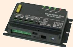
für 1-6 Module bis 360 W, automatische 12/24-V-Systemerkennung. Mikroprozessorgesteuerte MPPT-Technik (Maximum Power Point Tracking) nutzt effizient den aktuellen Ladestrom zur optimalen Batterieladung aus. Schützt vor Überladen und Rückentladen. Der eingebaute Bordnetzfilter sorgt für problemlosen Parallelbetrieb
