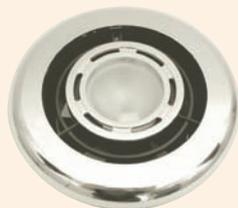
Kombigerät, bestehend aus Halogenleuchte und Ventilator, ideal für den Küchen- oder Badbereich. Leuchte mit Milchglasabdeckung. Der Abdeckring mit Bajonettverschluss ist zum Birnenwechsel drehbar. Ventilator leistungsstark zum Absaugen oder Belüften. Mit Einbaurahmen. Durch 3 bzw. 4 Schrauben einfach zu montieren. Äusserer Ring zur Montage ebenfalls zum Entfernen.
