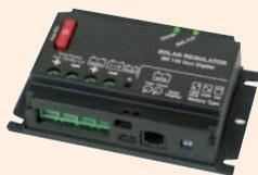
für 1-6 Module bis 240 W, automatische 12/24-V-Systemerkennung. Mikroprozessorgesteuerte MPPT-Technik (Maximum Power Point Tracking) nutzt effizient den aktuellen Ladestrom zur optimalen Batterieladung aus. Schützt vor Überladen und Rückentladen. Der eingebaute Bordnetzfilter sorgt für problemlosen Parallelbetrieb
