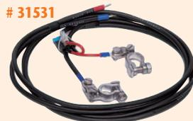
für die Verbindung von Solarladeregler und Batterieanlage. Erd- und kurzschlussicher, Plus- u. Minus-Leitung mit Batterieklammern und Aderendhülsen. Plus-Leitung zusätzlich mit Sicherungshalter und Flachsicherung 15 A.
