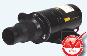
Klappt man den wasserdichten Verschluss auf der Rückseite zur Seite, kann man die Motorwelle mittels Schraubendreher manuell durchdrehen (falls der Impeller durch Fördergut blockiert ist).
