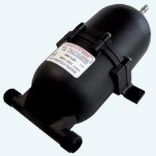
der Lebensdauer der Pumpe, Verkürzung der Ein- und Ausschalt-dauer, Schonung der Batterie. In beliebiger Lage montierbar. Eine Luftblase mit konstantem Druck wird von einer flexiblen Membran eingeschlossen. Der Druck der Luftblase ist auf 1,4 bar voreingestellt und kann mit einer Fahrradpumpe verändert werden. Optimale Funktion, wenn dieser Wert nahe dem Wiederein-schalt-Druck der Pumpe liegt.
