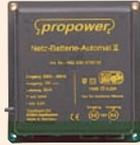
zur Stromversorgung von 12-V-Geräten aus dem 230-V-Stromnetz, TÜV/GS/CE geprüft. Mit automatischer Umschaltung „Netzbetrieb-Batteriebetrieb“, Sicherungsautomat, 1 m Kabel.
