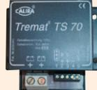
trennt und verbindet Start- und Versorgungsbatterie automatisch zur richtigen Zeit im Fahr- und im Standbetrieb. Zusätzlich unterbricht er den 12-V-Kühlschrankbetrieb bei stillstehender Lichtmaschine. Beim Laden erfolgt Parallelschaltung der Batterien, wenn Versorgungsbatterie 14,0 V erreicht. Trennung bei Unterschreiten von 13,0 V. Mit Schutzbeschaltung für die Lichtmaschine.
