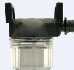
zum Einstecken in die Ansaugseite der Smart Sensor. Der große feinmaschige rostfreie Metallsiebkorb hält Schwebstoffe zurück. Der durchsichtige Deckel lässt erkennen, wann eine Säuberung nötig ist. Durch Bajonettverschluss einfache Reinigung, trinkwasserecht.
