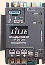
für 1-6 Module bis 300 W. Schützt vor Überladen und Rückentladen. Der eingebaute Bordnetzfilter sorgt für den problemlosen Parallelbetrieb mit Lichtmaschine, Ladegeräten, Trennrelais etc. Die Ladung mit zusätzlicher Gasungssteuerung und IU-Kennlinie sorgt für eine schonende Batterieladung. Die LED-Anzeige zeigt jeweils „LADEN“, „VOLL“, „UNTERSCHAN-“
