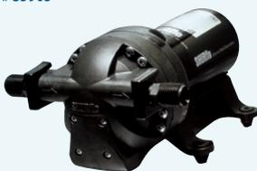
Druckwasserpumpe mit extrem hoher Leistung, aus der Extreme-Serie mit Druckschalter ohne elektronische Regelung, seewasserfest mit explosionsgeschütztem Motor. Mit der beliebigen Spritzpistole wird diese Pumpe zur Deckwaschpumpe. So erhält man ein Hochdruckgerät mit einem kräftigen Strahl von 3,1 bar.
