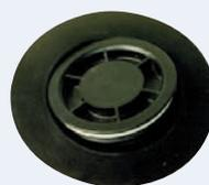
aus PE, zum Verschweißen mit PE-Platten oder Tanks. Interessant für Tankbauer, die PE verschweißen können. Mit Deckel (AG-Ø 120 mm) Außenmaße: 200 x 200 mm, (5 cm-Bund zum Verschweißen, breiter als abgebildet).
