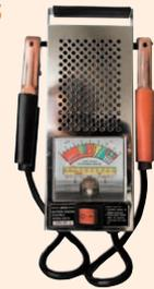
misst Batteriespannung bei Stromfluß von ca. 100 Ampere. Ist die Batterie o.k., bleibt die Spannung nahezu konstant, hat sie einen Mangel, bricht die Spannung ein. Skala für versch. Batteriegrößen und -typen.
