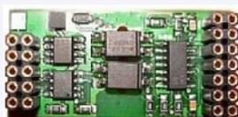
Datenschnittstelle zum Verbinden der Wechselrichter mit dem Datenlogger (#AW0016, siehe unten).
