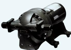
Frischwasserpumpe mit höchster Leistung und elektronischer Regelung, seewasserfest mit nahtlosem funkengeschütztem, explosionsgeschütztem Motor, wassergeschützter Sicherung 15 A in der Plusleitung, Zusatzdichtungen zwischen Pumpkopf und Antrieb
