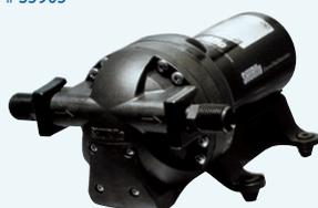
Druckwasserpumpe mit extrem hoher Leistung, aus der Extreme-Serie mit Druckschalter ohne elektronische Regelung, seewasserfest mit explosionsgeschütztem Motor. Mit der beiliegenden Spritzpistole wird diese Pumpe zur Deckwaschpumpe. So erhält man ein Hochdruckgerät mit einem kräftigen Strahl von 3,1 bar.
