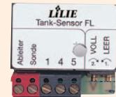
für Frisch- und Abwasser- und Fäkal tanks aus Kunststoff oder Metall, mit flexibler Seilsonde. Die gekapselte Elektronik sorgt für eine zuverlässige stufenlose Datenübermittlung, ideal daher für Unterflur. Die Meßwerte werden elektronisch komprimiert und über nur 2 Kabel zum Panel geführt. Mit Umschalter und Montageteilen.
