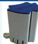
Schaltet die Piranha-Pumpe (siehe auch S. 34) bei einem Wasserstand von mehr als 3,5 cm ein und bei einem Wasserstand von weniger als 1,5 cm wieder aus.
