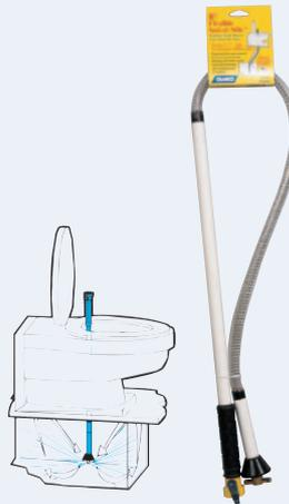
löst und sprüht Ablagerungen von Tankwänden und -ecken. Erzeugt aus Wasserdruck des Schlauches eine schnelle Drehbewegung und bewirkt so eine kraftvolle Rundum-Reinigung. Am Griff befindet sich ein Absperrventil. Alle beweglichen Teile bestehen aus Messing. Patentiert. Der flexible Swivel Stik ist mit einem 75 cm langen Schlauch mit korrosionsbeständiger Feder ausgestattet.
