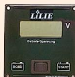
Kontrolltafel zur genauen Messung der Bordspannung von Starter- und Versorgungsbatterie. Messauflösung: 0,1 V, Messbereich: 9 bis 30 V. Komplett mit Anzeige, diversen Kleinteilen und Anleitung.
