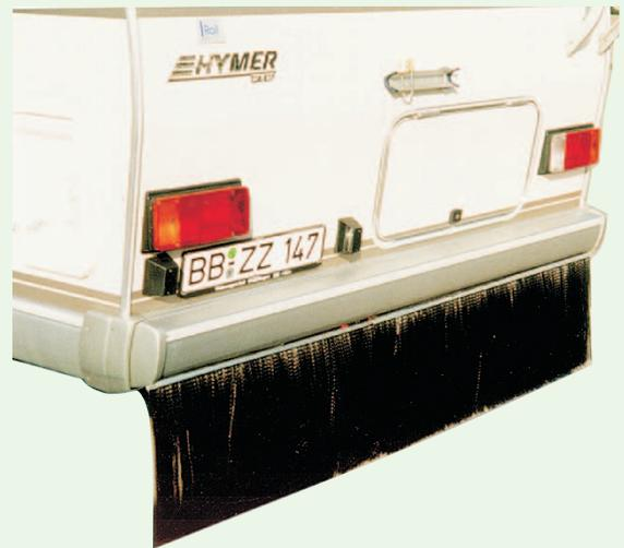
schützt vor Schmutz, Spritzwasser, Schneematsch, Regenfontänen. Hält Heckwand, -fenster, Fahrräder, Roller, Heckbox und Anhänger sauber. Für Mobile, Geländewagen und Hängerbetrieb. 57 cm lange starke Perlon-Fäden sind zu einer 122-cm-breiten Bürste zusammengefaßt. Die Breite von 2,44 m kann durch Abschneiden an das
