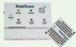
Autarkes Warnsystem mit eingebautem Kombi-Sensor und Sirene mit 85 dB. Warnt schon bei geringsten Konzentrationen von KO-Gas oder Butan/Propan/ Methan. Schaltausgang mit 1 A für externe Warneinheiten (z.B. Blitzlicht o.ä.). Anschlussmöglichkeit für 2 externe Zusatzsensoren (nicht im Standardlieferungsumfang). Mit Ein-/Ausschalter, Betriebsanzeige und Anleitung
