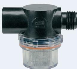
zum direkten Aufschrauben auf SHURflo-Pumpen. Feinmaschiges, rostfreies Metallsieb stoppt Teile, die sonst Pumpe und Wasseranlage schädigen könnten. Die aufgeschraubte transparente Filtertasse ermöglicht eine einfache Reinigung, trinkwasserecht.
