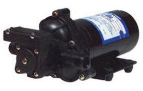
Alle Pumpen der Serie Aqua King sind 3-Kammer-Membranpumpen zur automatischen Versorgung von Frischwasser. Sie sind seewasserfest. Der Motor ist schutzlackiert, der Druckschalter und die elektrischen Verbindungen sind vollständig gekapselt, Zusatzdichtungen schützen den Antrieb.
