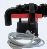
Ventil dient zum komfortablen Öffnen und Schließen von Wasserkreisläufen. 1 1/4" Wanddurchführungsanschluss incl. Dichtung und Befestigungsmutter. 90°-Abgangsstützen mit 30 mm Durchmesser. Ventil ist über einen 4-poligen Schalter ansteuerbar, der aber nicht im Lieferumfang enthalten ist. Anschlussplan mit PIN-Belegung wird mitgeliefert. Das Ventil kann im Notfall (z.B. bei Stromausfall) auch manuell
