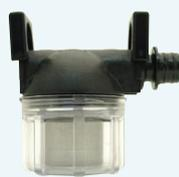
Zum Einstecken in die Ansaugseite der Smart Sensor. Schützt Pumpe und Wasseranlage. Der große feinmaschige rostfreie Metallsiebkorb hält Schwebstoffe zurück. Der durchsichtige Deckel lässt erkennen, wann eine Säuberung nötig ist. Durch Bajonettverschluß einfache Reinigung, trinkwasserecht.
