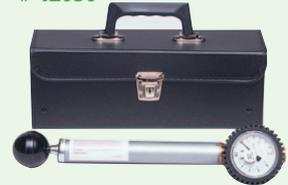
für Flüssiggasanlagen. Verstärkte Ausführung mit hoher Pumpleistung und Überdrucksicherung. Fein-Meßbereich 0 - 250 mbar, Grob-Meßbereich bis 2 bar. Im Koffer mit Lecksuchspray, Anschlußschlauch und 5 Übergangsstücken für sämtliche Prüfanschlüsse
