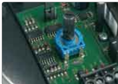
Potentiometer für Temperaturdifferenz und Maximal- bzw. Minimaltemperaturbegrenzung
