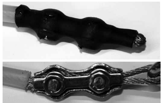
Abb. 9 Einstellung des Kabels Anpassung unter dem Heißschumpfschlauch (obere Abbildung) Heißschumpfschlauch entfernt (untere Abbildung)
