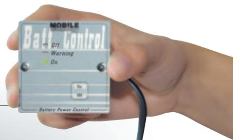
■ Werden einfach in die Plusleitung der Bordbatterie geschaltet und schützt diese vor schädlicher Über- oder Unterspannung. Tritt eine für die Batterie nicht sachgemäße Spannung auf, trennt der **USG** die angeschlossenen Verbraucher ab und schützt Batterie und angeschlossene Verbraucher gleichermaßen. Werden die programmierten Schaltschwellen wieder erreicht, werden die Verbraucher automatisch wieder zugeschaltet.
