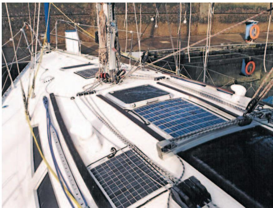
Für den Marine-Einsatz gibt es spezielle, begehbare Ultraflach-Module, die direkt auf das Deck aufgeklebt werden.
