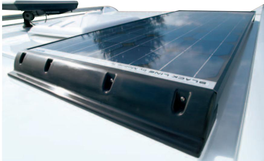
Bewährte Lösung: Durch die Montage der Solarmodule auf Spoilerprofile, die dann auf dem Reisemobildach sicher verklebt werden, wird eine optimale Unterlüftung der Module garantiert.
