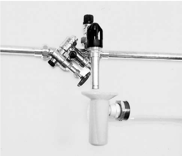
Bild 10 Option: In Kaltwasserleitung oberhalb des Speichers die Sicherheitsgruppe anstatt Absperr-, Rückschlag- u. Sicherheitsventil einbauen. Keine Absperrung zwischen Sicherheitsgruppe u. Speicher!
