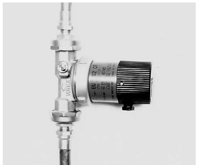
Bild 13 Option: Wenn gewünscht Brauchwasserzirkulations-Pumpe nach Anschlussplan einbauen und Rohranlagefühler möglichst nahe der letzten Warmwasserzapfstelle montieren.
