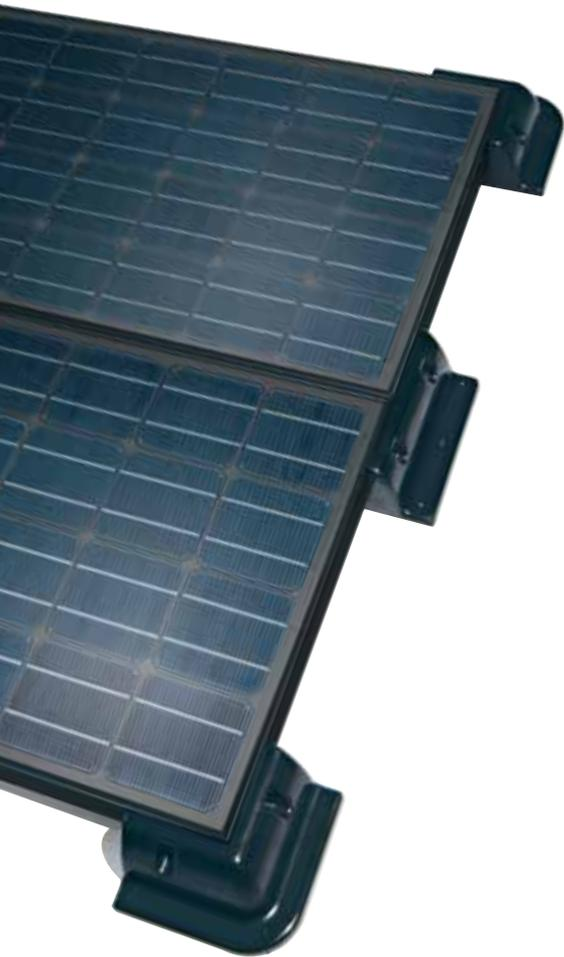
■ Diese PUR-Montageprofile können für jedes Solarmodul mit Aluminiumrahmen verwendet werden. Ohne zu bohren können mit einem Klebe-Set (s. S. 43) auch diese auf serienmäßig lackierten Flächen bzw. GFK-Untergründe aufgeklebt werden. An den Befestigungsfenstern der Halterungen werden die Solarmodule einfach mit den im Klebe-Set enthaltenen Edelstahlschrauben am Alu-Rahmen angeschraubt. Die extrem witterungsbeständigen Halte-
