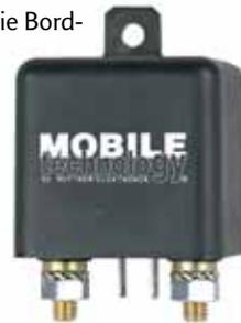
verbraucher die Starterbatterie entladen wird und somit nicht mehr genug Leistung zum Starten des Motors zur Verfügung steht. Wird dann der Motor gestartet und die Lichtmaschine gibt Ladestrom ab, sorgt das Trennrelais dafür, dass die Bordbatterie parallel über die Lichtmaschine wieder geladen wird. Das Relais enthält eine Löschiode zum Unterdrücken induktiver Spannungsspitzen.
