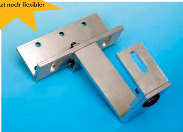
Bild 15 Der neue Sparrenanker F ist sehr flexibel. Er kann für unterschiedliche Dachlattenstärken verwendet werden, kann Dachunebenheiten ausgleichen und bietet schließlich ein Langloch zur flexiblen Anordnung der Montageschiene. Kräftige Querschnitte sorgen für ein Plus an statischer Sicherheit.
