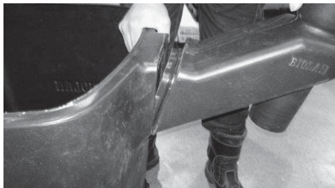
Abb. 1 Positionieren Sie den Luftkanal (Einzelteil Nr. 7) im Gehäuse.
