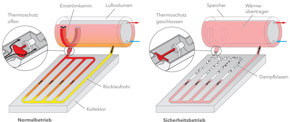
Im Normalbetrieb ist der Thermoschutz geöffnet, der natürliche Konvektionskreislauf zwischen Kollektor und Wärmetauscher findet über den Einströmkamin statt. Dieser ist zur optimalen Wärmeschichtung U-förmig ausgeführt.
